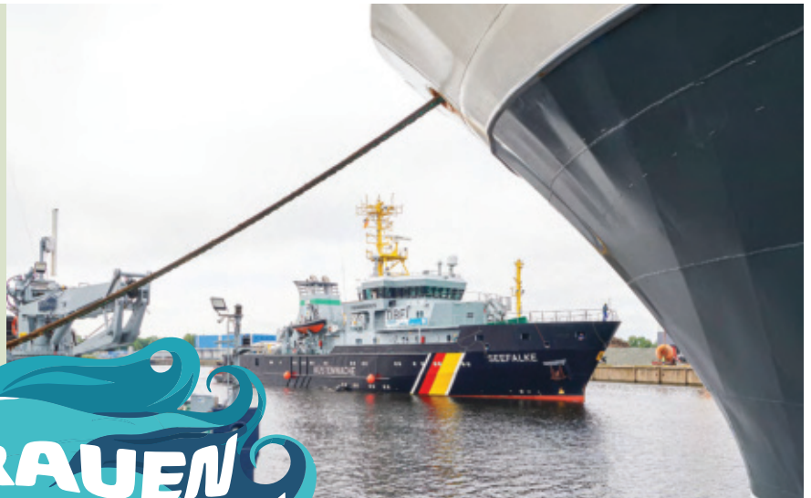
Seefalke. Das moderne Fischereischutzboot (Indienststellung: 2008) ist knapp 73 m lang und 13 m breit und hat einen Tiefgang von gut 5 m. Die dieselektrische Maschinenanlage leistet 2 x 3.600 Kilowatt (kW).
